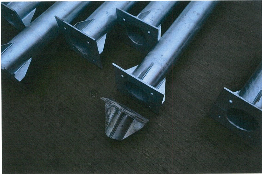
Fotografía N° 20: Suministro para el cambio de postes de alumbrado.
